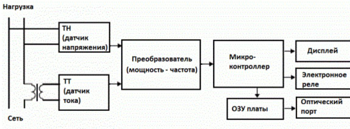
Рис.1 – Принципиальная схема электронного счётчика.
