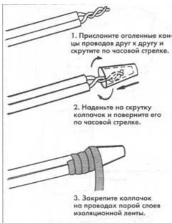
Рисунок 2 – Соединение жил кабеля
