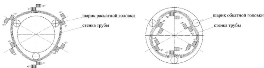
Схема деформации трубы при раскатывании
