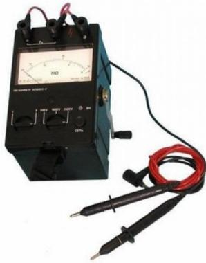
Как правило, для измерения сопротивления изоляции оборудования номинальным напряжением до 1000 В (цепи вторичной коммутации, двигатели и т. д.) используют мегомметры на номинальное напряжение 100, 250, 500 и 1000 В, а в электрических установках с номинальным напряжением более 1000 В применяют мегомметры на 1000 и 2500 В.
